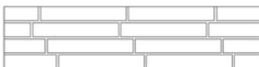
Junta mínima de assentamento de 2 mm.
